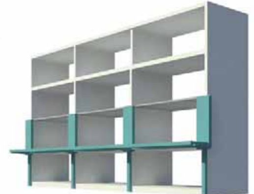
3. balkonplaten worden op de consoles gelegd
