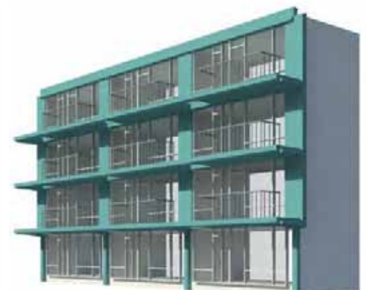
6. dakrand wordt op de consoles gelegd
