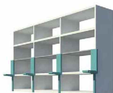
2. consoles op de kolommen
